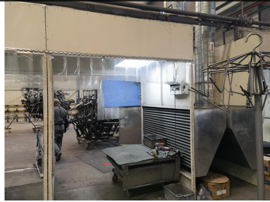
打磨工位侧吸集气罩及围挡软帘
