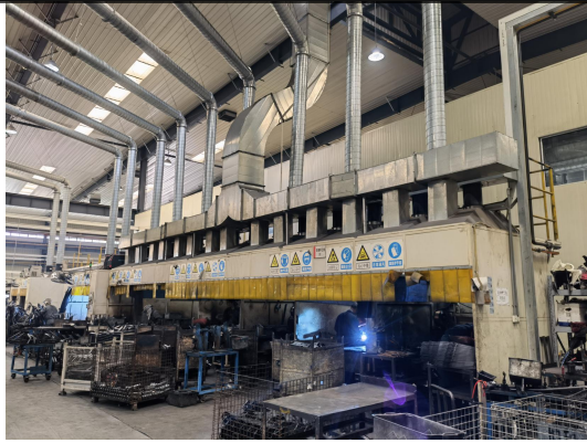
焊接工位及废气集气罩
